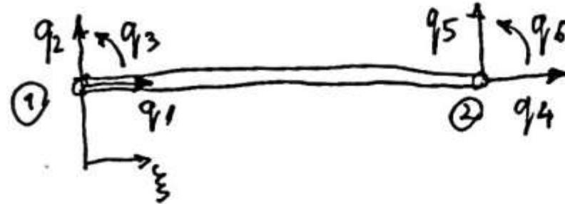
$$\{q\}_{6 \times 1} = \begin{Bmatrix} q_1 \\ q_2 \\ q_3 \\ q_4 \\ q_5 \\ q_6 \end{Bmatrix}$$
